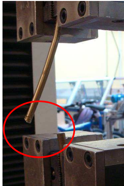
Rupture du câble
