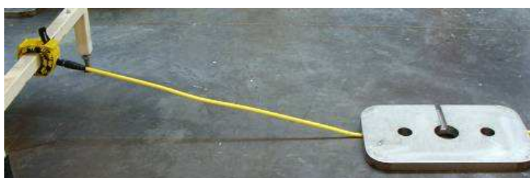
Méthode de mise en contrainte du câble (tendu)
