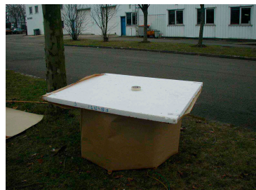
Protocole des tests de projection à l'air libre (papier Kraft de 1m de large tendu à une distance de 0,50 m de l'appareil)
