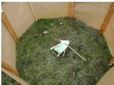
Protocole des tests de projection à l'air libre (papier Kraft de 1m de large tendu à une distance de 0,50 m de l'appareil)
